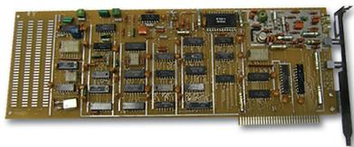
Первая серийно выпускаемая система CVS на четыре канала – GUARD-4. Отечественная элементная база. АЦП – 6 бит. MS-DOS.
